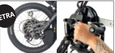
Podwójne zaciski hamulcowe na tarczach 200/203 mm i czujnik hamulca z odcięciem zasilania. Uchwyty kierownicy BATEC QUAD GRIPS.
