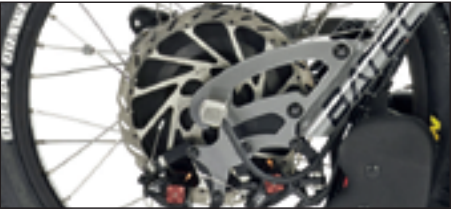
Bezsztotkowy silnik o wysokim momencie obrotowym 250 obrotów na minutę. Moc znamionowa: 900 W. Moc szczytowa: 1050 W.
