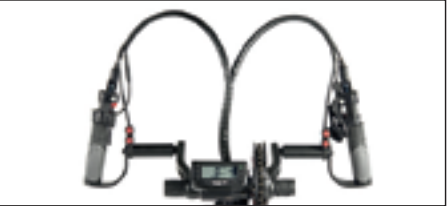
Nowa elektronika z 3 poziomami wspomagania + tryb E. Czujnik odcięcia zasilania hamulca.
