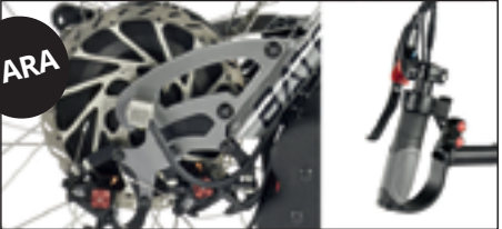
Podwójne zaciski hamulcowe na tarczach 200/203 mm z dźwigniami hamulcowymi i czujnikiem odcięcia zasilania Saccon.
