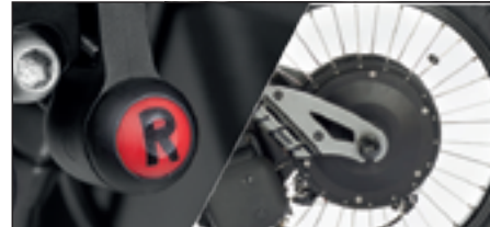
Bezsztotkowy silnik o wysokim momencie obrotowym 250 obrotów na minutę z biegiem wstecznym. Prędkość maksymalna 25 km/h.
