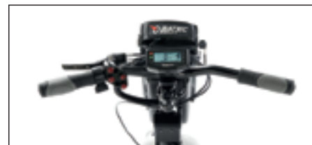
Opcjonalna kierownica z pojedynczą dźwignią hamulców po prawej lub lewej stronie kierownicy dla osób z hemiplegią.
