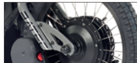
Zdejmowany prawy hak widelca ułatwia wymianę dętki lub opony.
