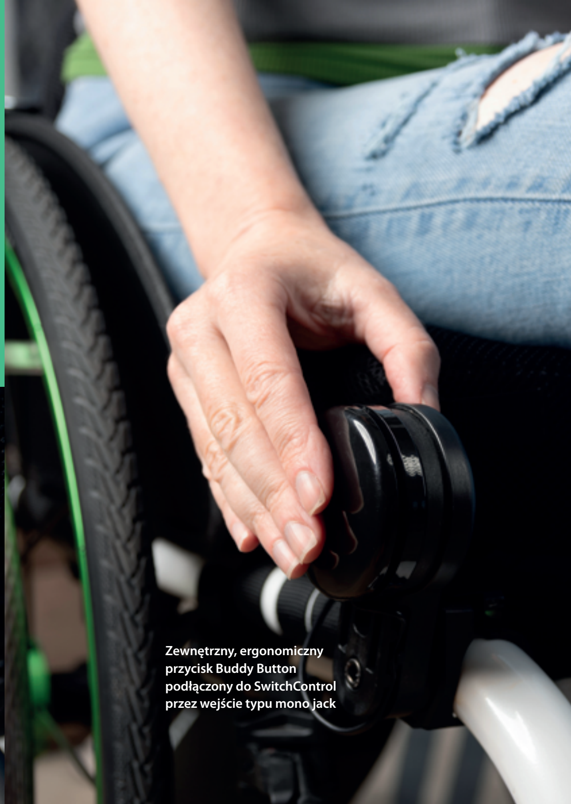
Sterowanie SwitchControl zamontowane na ramie wózka
